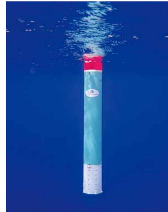
海中を自動で昇降し観測を行うフロート。比較的小型軽量で、取り扱いやすいことが特徴です。CTDセンサを搭載し、海中の塩分、水温、水深を観測します。観測データは、浮上時に自動で発信され、陸上にて受信することができます。また、搭載するセンサは、用途に応じてカスタマイズが可能です。
